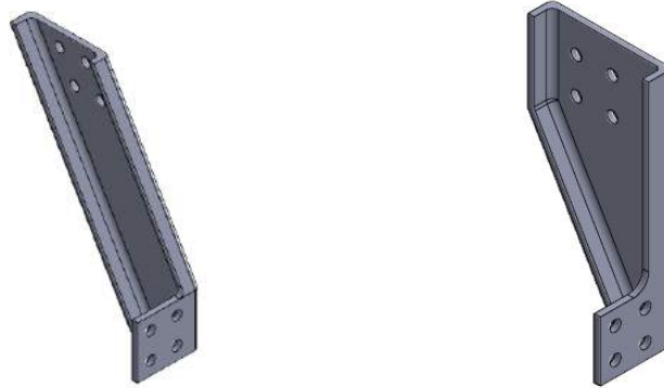
شكل 24: نموذج لجسر يستخدم مع هيكل شاحنة ذو مقطع أي (C-section beam)
